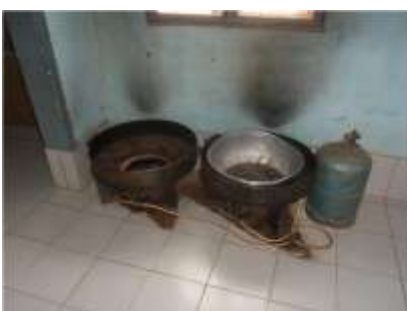
Fourneau alimenté au gaz butane
